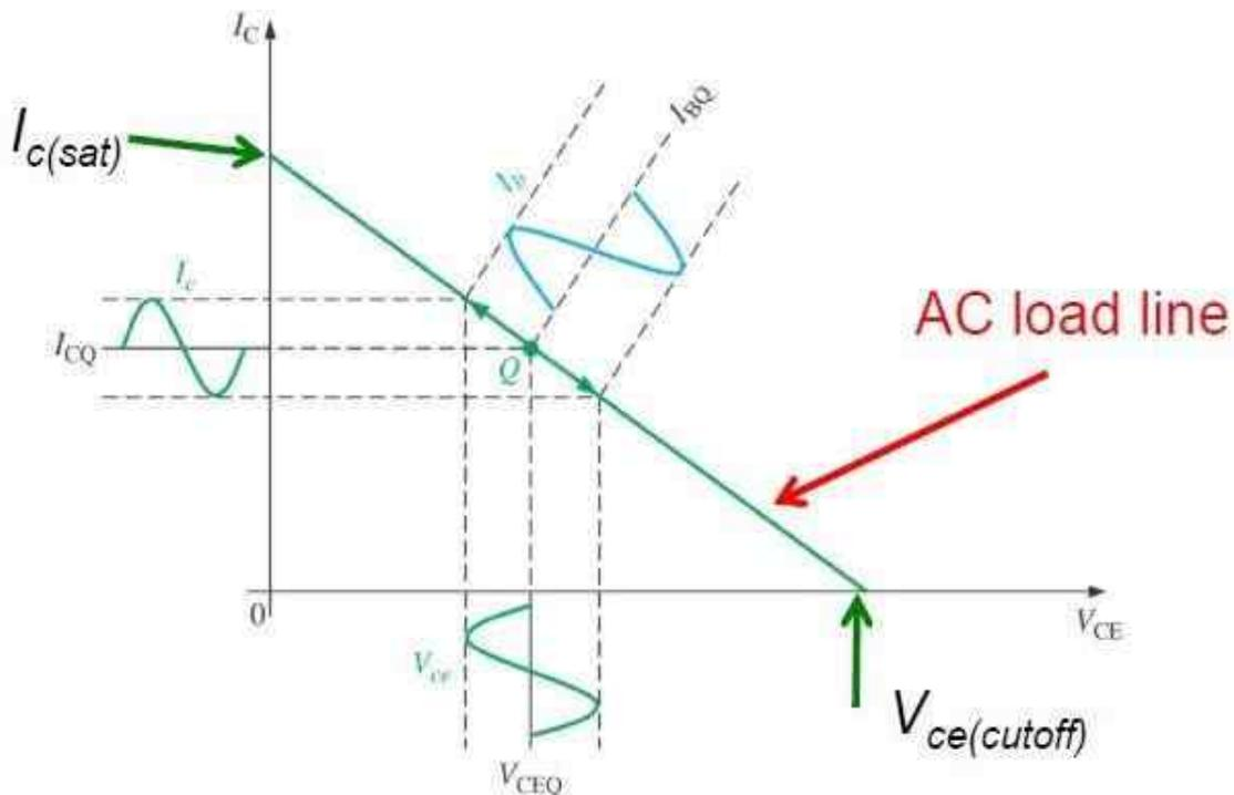
$$V_{CE\max} = V_{CE} + I_C R_{AC}$$
